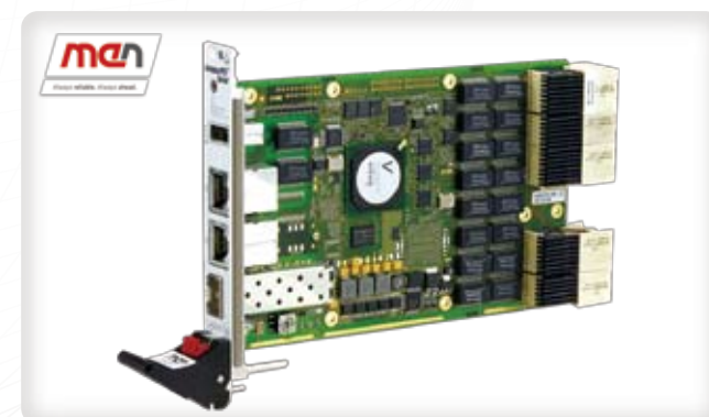
スイッチ Model: G101 ◇ Gigabit Ethernet × 25 ◇ EN50155 class Tx ◇ RJ45, M12 ◇ Managed 耐環境性3U CompactPCI Serialイーサネットスイッチ
