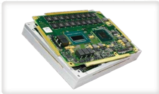
Intel Model: CB70C ◇ Intel ◇ ~2.5GHz ◇ Core i7 ◇ ~16GB DDR3 Core i7搭載 耐環境性 COM Express CPUカード
