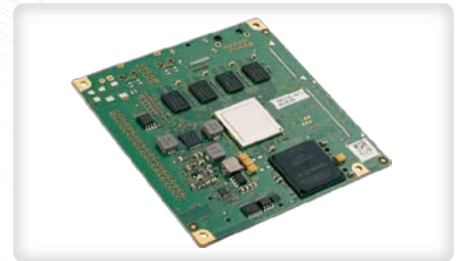
ARM Model: CC10C ◇ ARM ◇ ~1.0GHz ◇ i.MX6Q ◇ ~4GB DDR3 ARM iMX6Q搭載 耐環境性COM Express CPUカード
