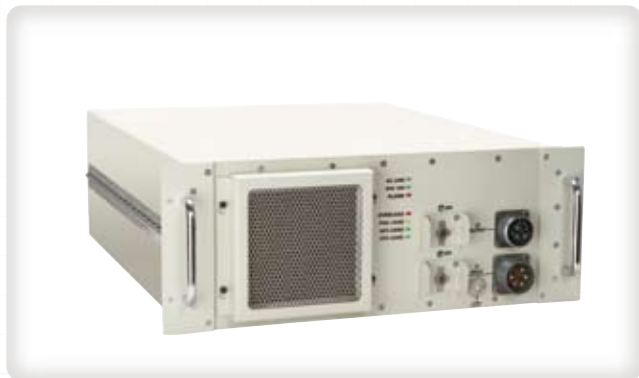
コンバーター / UPS Model:ED4-4000 ◇入力: 400Hz, 三相4.0KVA ◇UPS Opt. ◇出力: 単相120Vac, 2800W 耐環境性周波数、位相コンバーター
