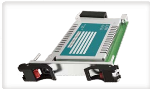
ストレージ Model: OpenVPX 5334 ◇3U SATA ◇2.5" × 2 ◇VITA 65 ◇1TB OpenVPX対応3Uストレージボード R EX CC MIL
