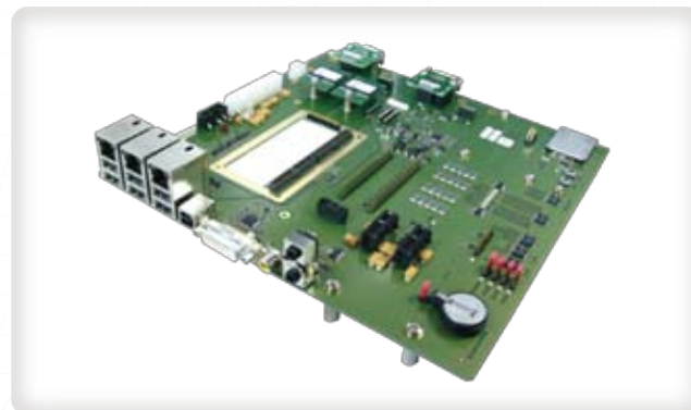
キャリアー Model: XC4 ◇ microATXファクター ◇ Fast Ethernet × 2 ◇ ESMexpress × 1 ◇ USB 2.0 × 6 ESMini用キャリアボード
