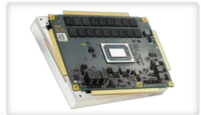
AMD Model: CB71C ◇ AMD ◇ ~32GB DDR4 ◇ V1000 APUシリーズ ◇ 4コア, ~3.35GHz AMD APU搭載 耐環境性 COM Express CPUカード
