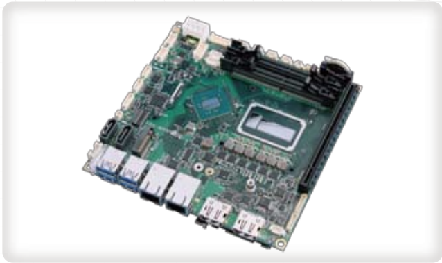
Intel Model: SX-8030 ◇ 145 × 140mm ◇ DDR4 SO-DIMM ◇ ECC ◇ ワイドレンジ単一電源動作 6th Gen Intel Xeon Core i7/i5/i3/Celeron搭載CPUボード FAN L JPN
