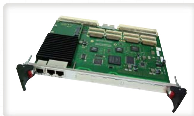
PowerPC Model: A21B/21C ◇ PowerPC QorIQ ◇ P1013, Single or Dual-Core P1022 ◇ 800MHz, 1.067GHz ◇ ~2GB DDR3 ◇ M-Module/XMC or PMC slots QorIQ PowerPC搭載 VMEボード
