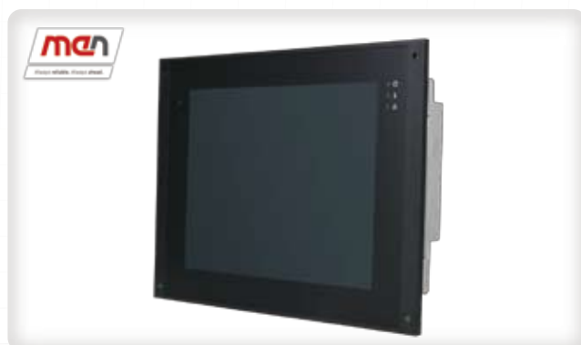
パネルコンピュータ Model: DC17 ◇ 12.1" LED backlight ◇ IP65 ◇ AMD G-Series ◇ 1.0GHz ◇ ~40~+70°C ◇ 2GB DDR3 ◇ EN50155 AMD搭載ファンレスCPUカード内蔵ディスプレイ
