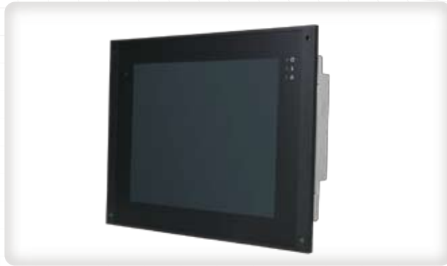
パネルコンピュータ Model:DC17 ◇ 12.1" LED backlight ◇ AMD G-Series ◇ -40~+70°C ◇ EN50155 ◇ IP65 ◇ 1.0GHz ◇ 2GB DDR3 AMD搭載ファンレスCPUカード内蔵ディスプレイ R EX CC WR
