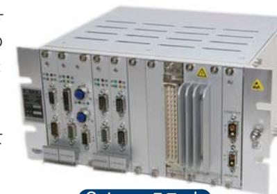
EKE-Trainnet® GatewayはIEC61375規格TCN通信に準拠したシステムで、UIC556アプリケーション機能をサポートしています。このゲートウェイシステムは列車バス(WTB,ETB)、車両バス(CAN,LON,MVB,ECN等)、CPU、電源の4つのサブシステムから構成され、全体として迅速で信頼性のあるバス間の通信を実現しています。
